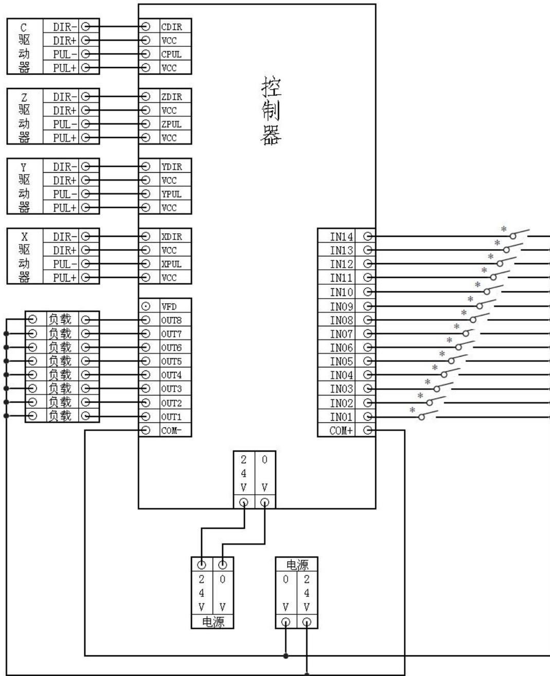
\* 各传感器的控制输出请使用NPN型。
